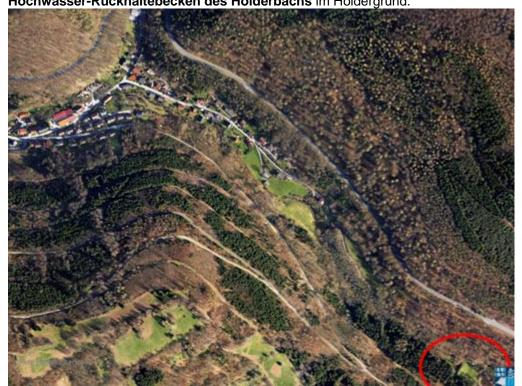
Eine wesentliche Verbesserung der Sicherheit für die Anlieger des Holderbachs wird die angestrebte Vergrößerung des Hochwasserrückhaltebeckens im Oberlauf sein (hier rot umrandet).
